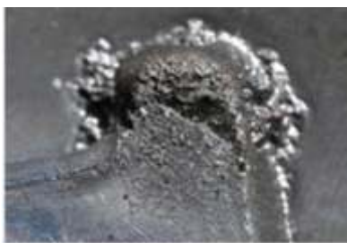
Die Erosion (Metal Impingement)
